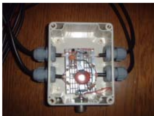
同調型微小ループアンテナの内部
