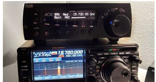
AR7030+LCD-B&W-Reverse: Guy 氏の最近の DIY プロジェクトの 1 つ。AR7030 Plus の LCD ディスプレイの交換
