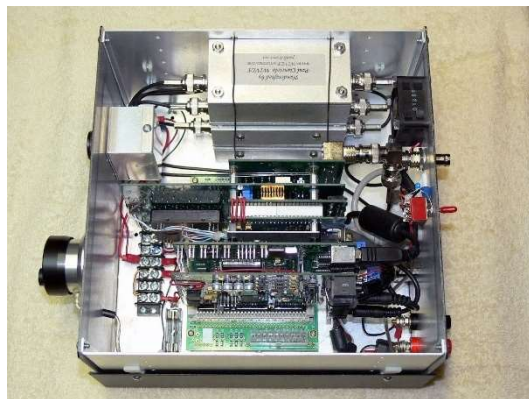
FlexRadio SDR-1000 に自作ハイパスフィルタ/ローパスフィルタ、及びサウンドカードを組み込んだもの。こうした芸当が可能な技術力を有する
